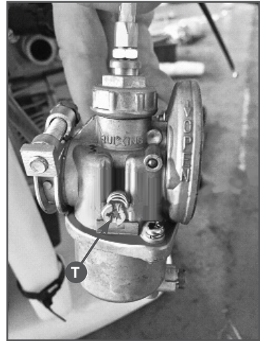
Рис. 16 Расположение винтов регулировки карбюратора
