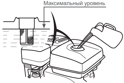
Рис. 13 Максимальный уровень топлива в топливном баке
